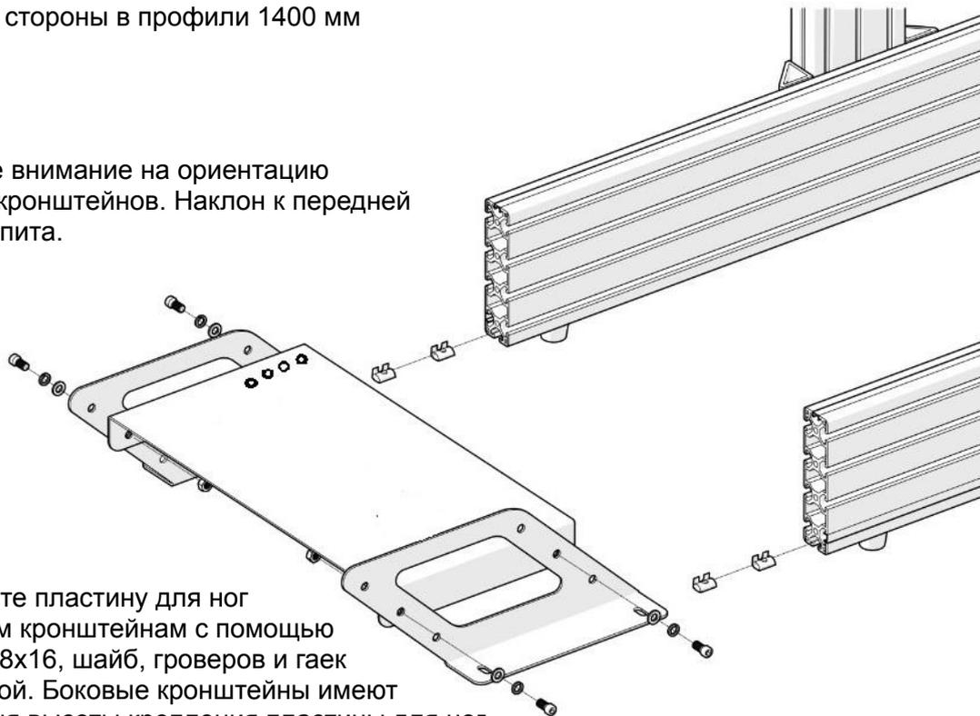
Прикрутите пластину для ног к боковым кронштейнам с помощью винтов M8x16, шайб, гроверов и гаек M8 с юбкой. Боковые кронштейны имеют три уровня высоты крепления пластины для ног.
