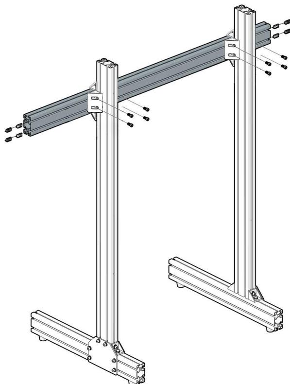
В горизонтальный профиль перекладину в верхний и нижний слот установите по 2 пазовые гайки М8 для крепления торцевых силовых уголков. А также установите по 4 пазовые гайки М8 в задний верхний и нижний слоты профиля для крепления боковых силовых уголков. Двенадцать винтами м8х16 прикрутите силовые уголки к горизонтальному профилю. Окончательную затяжку производите после выставления нужной ширины и высоты.. (Винт М8х16 - 12 шт, пазовая гайка М8 - 12 шт).
