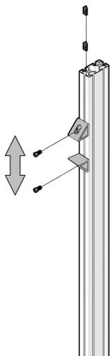
В вертикальные профили установите по две пазовых гайки М8 в передние слоты для крепления дополнительных силовых уголков.
