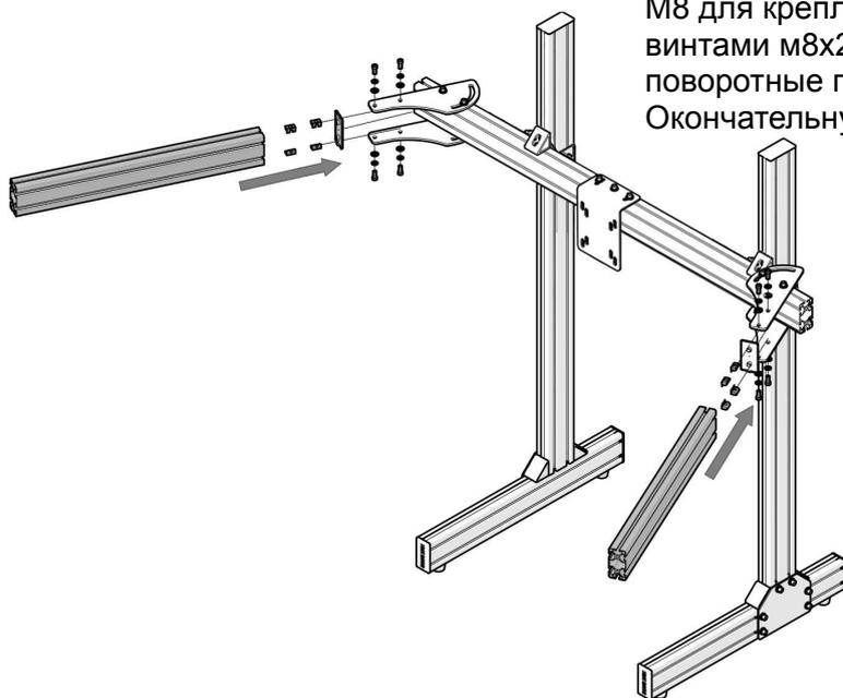
В каждый горизонтальный боковой профиль установите в верхний и нижний слоты по 2 пазовые гайки М8 для крепления поворотных кронштейнов. Восемью винтами м8х20 с шайбами и гроверами прикрутите поворотные пластины к боковым профилям.
