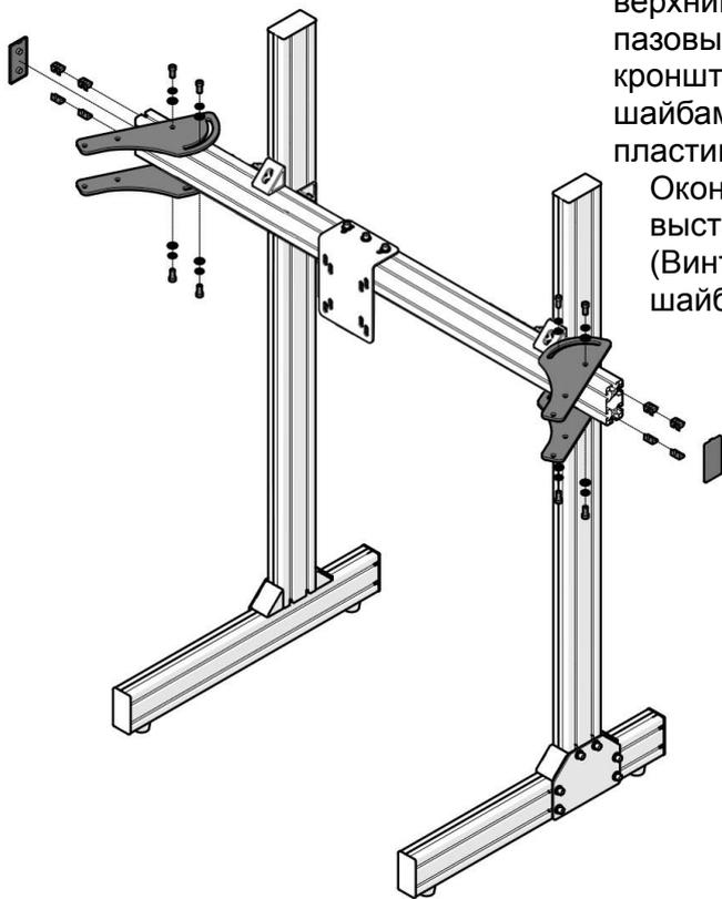
В горизонтальный профиль перекладину в верхний и нижний слоты установите по 4 пазовые гайки М8 для крепления поворотных кронштейнов. Восемью винтами м8х20 с шайбами и гроверами прикрутите поворотные пластины к горизонтальному профилю.
