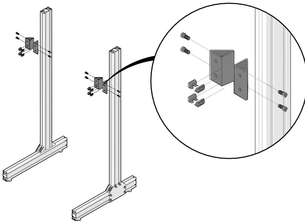
В горизонтальный профиль вставьте в верхний слот 3 пазовые гайки М8. Тремя винтами М8х20 с шайбами и гроверами прикрутите кронштейн монитора. Рекомендуем крепить до момента крепления силовых уголков.
