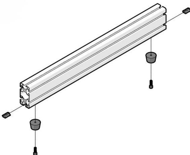
Установите в нижние слоты профилей 580 мм по две пазовые гайки М8. Прикрутите к ним резиновые ножки четырьмя винтами М8х20. (Винт М8х20 - 4 шт, пазовая гайка М8 - 4 шт, ножка - 4 шт).
