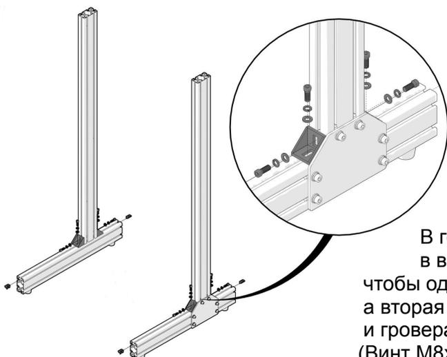
В горизонтальные профили 580 мм вставьте в верхний слот по две пазовые гайки М8. Так чтобы одна располагалась до вертикальной стойки, а вторая после. Восемью винтами М8х20 с шайбами и гроверами через четыре уголка скрутите профили. (Винт М8х20 - 8 шт, пазовая гайки М8 - 8 шт, уголок соединительный - 4 шт, шайба - 8 шт, гровер - 8 шт).
