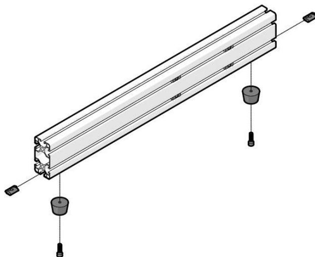
Установите в наружные, а также передние и задние слоты самых длинных профилей по одной пазовой гайке М8. (Пазовая гайка М8 - 8 шт).
