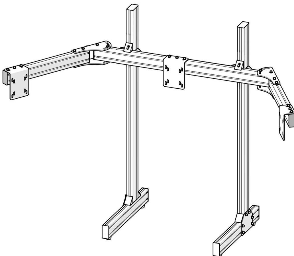
Установите в наружные слоты профилей 40x80 длиной 580 мм по четыре пазовые гайки М8 (Пазовая гайка М8 - 8 шт)
