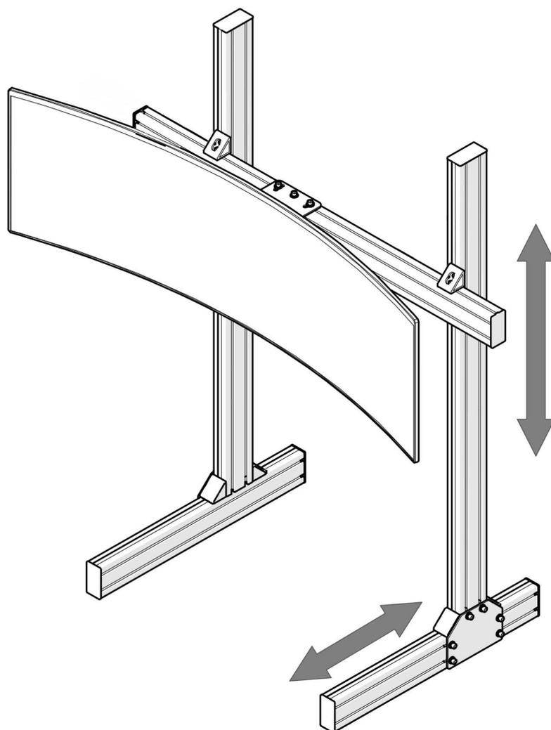
Установите в наружные слоты профилей 40x80 длиной 580 мм по четыре пазовые гайки М8 (Пазовая гайка М8 - 8 шт)
